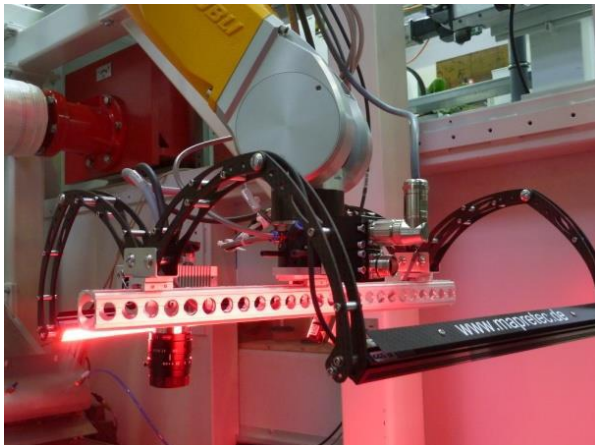
Bild 8:a) Qualitätssicherungseinheit (OCQU); links am 6-Achs Knickarmroboter zur Erfassung von textilen Oberflächenfehlern nach der Ablage; rechts: Beispielhaft erfasste textile Oberfläche eines multiaxialen Carbongeleges mit ausgewerteten Faserverläufen (rot: Nähfäden; grün: Zwischenräume)
