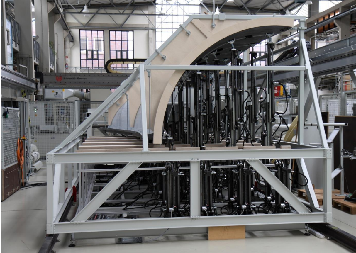
Bild 7: Auf das zu untersuchende Rotorblattsegment in x-, y- und z-Position eingerichtete hydraulische Aktuatoren
