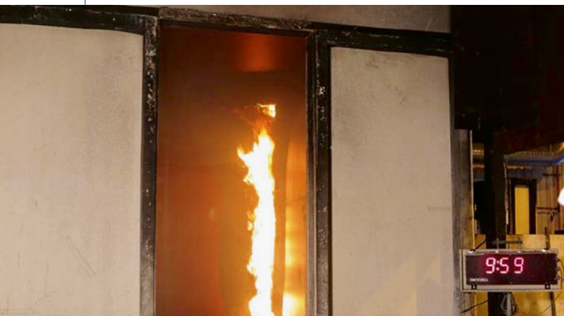
BILD 7 Raum-Eck-Test nach circa 10 min Beflammung bei 100 kW (© Saertex)
